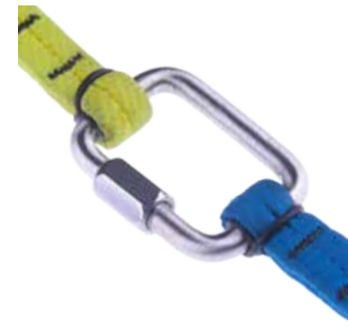
Indem man am Schluss noch ¼ Umdrehung mit einem Schraubenschlüssel macht, wird der Karabiner fest verschlossen.
